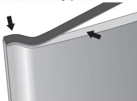
Rys.2 Montaż uszczelki z góry i z dołu
