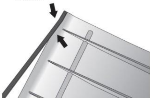
Rys.3 Montaż uszczelki po prawej i lewej stronie ceramiki
